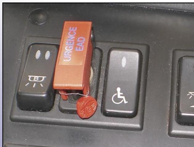
Blocage des commandes au tableau de bord
